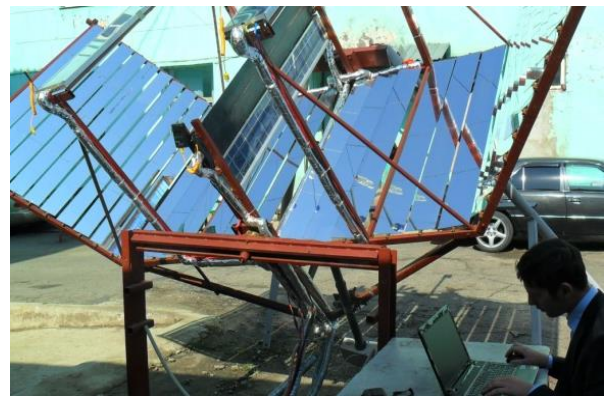
Рис. 1. Оптическая схема и лабораторная установка с фотомодулями
